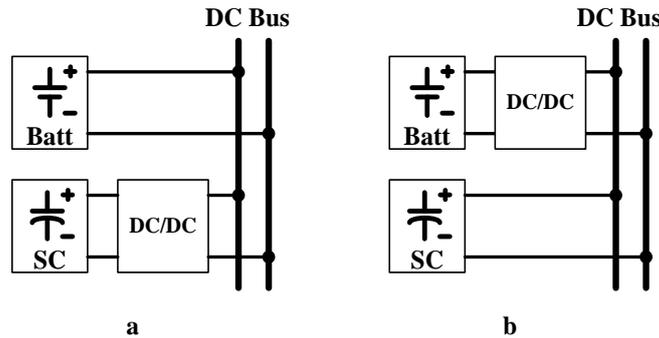
**Fig. 3. Semi-Active HESS Topologies**
